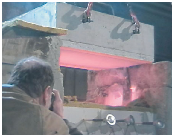
Brandversuch mit Perlit-Baustoff
