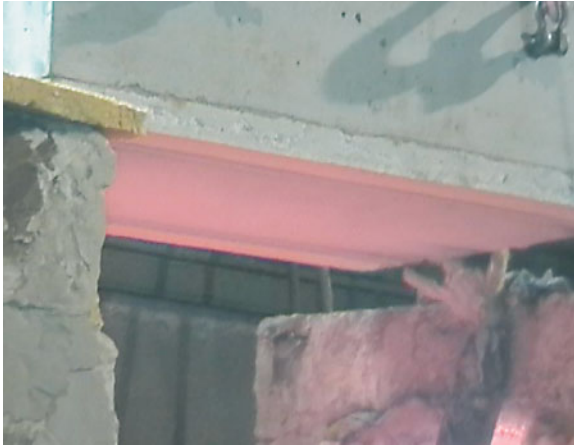
Beim Brandversuch wurde der Probekörper schockartig erhitzt
