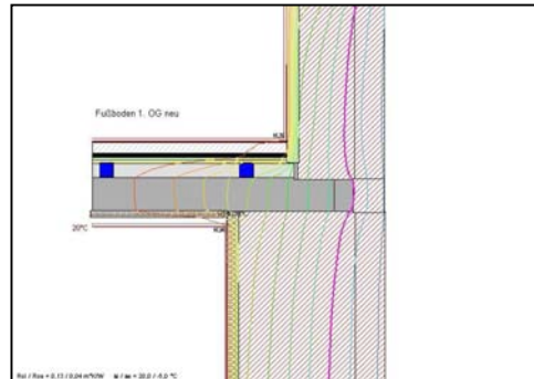
Bild 7: Wärmebrückensimulationenberechnung einbindende Decke Erdgeschoss
